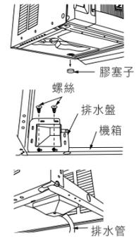
排水盤能在不同方向被安裝，請參考如下。此外，請使用兩粒附加螺絲鎖緊以防止漏水問題：
