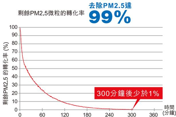
由日本Johnson Controls-Hitachi Tochigi Factory以JEM1467進行測試，配合納米鈦不銹鋼塗層前置過濾網，在面積25m<sup>3</sup>的房間以RA13RDF在高風速和淨冷模式下運行，PM2.5微粒在300分鐘後被去除。
