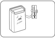
② 高溫時為避免機器過度運作而造成 損壞, 保護裝置將會起動, 因此可 能出現運作停止的現象。
