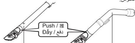
Telescopic pipe 伸縮管 Ống hút kéo dài أنبوب تليسكوبي Curved joint pipe 彎接頭管 Ống nối cong ماسورة التوصيل المنحنية
