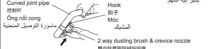
Curved joint pipe 彎接頭管 Ống nối cong ماسورة التوصيل المنحنية Hook 扣子 Móc المشبك 2 way dusting brush & crevice nozzle 雙向除塵刷與縫隙吸嘴 Chổi bụi và đầu hút khe 2 chiều
